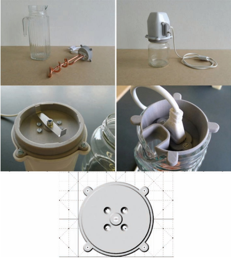
Resim 4. OpenStructures kılavuzu üzerinde bir parça tasarımı ve parçanın hem su ısıtıcı hem de doğrayıcı için kullanılması (Jesse Howard, 2012, http://blog.openstructures.net/pages/transparant-kitchen-tools-by sitesinden, 27 Haziran 2014 tarihinde alındı.)
